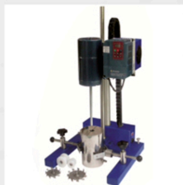
лабораторный диспергатор (диссольвер) с электрическим подъемом
